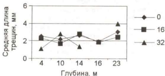
Рис. 4. Зависимость средней длины трещин от глубины (каждая кривая описывает поведение одного образца после циклов замораживания – оттаивания)
