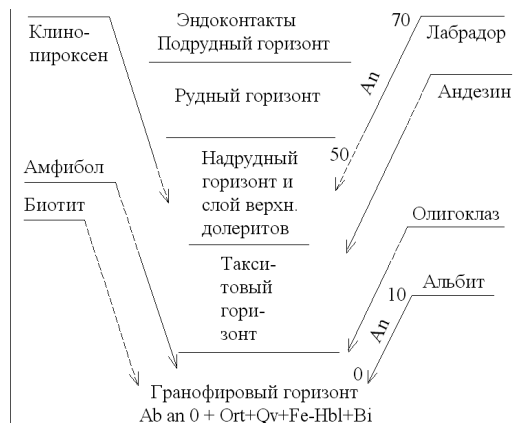
Рис. 5. Смена минерального состава в дифференцированных слоях и горизонтах интрузива (вилка Боуэна)
