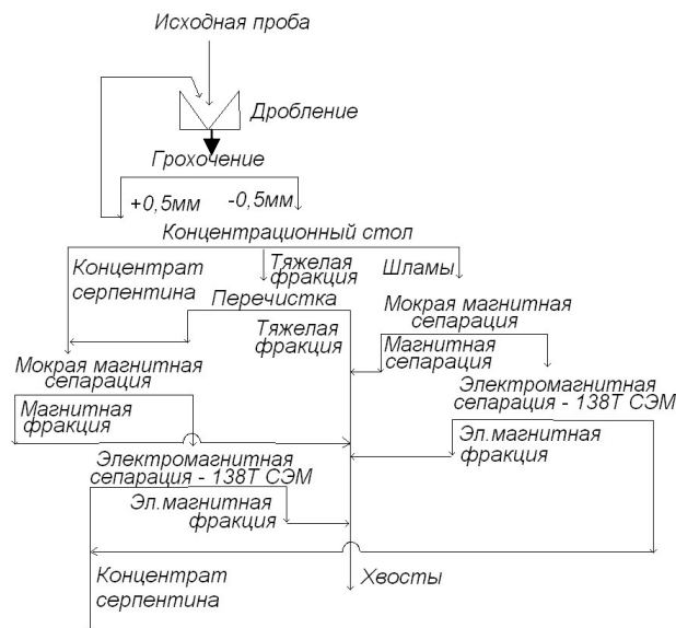
Рис. 3. Схема обогащения пробы № 323 серпентинита Аганозерского объекта
